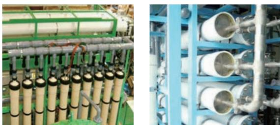
● MF膜(Microfiltration膜)は0.05~10μmの大きな大腸菌やコロイド状シリカなどを分離します。
