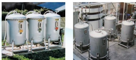
● イオン交換樹脂は左図のように塩分を含んだ排水から純度の高い水が回収できます。
